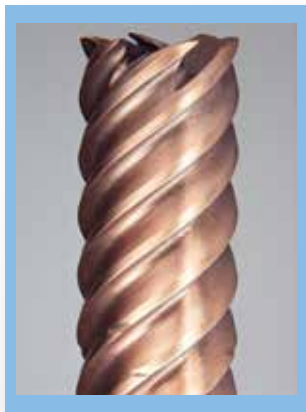
直径 d 8 mm 使用 58 分钟后的磨损情况。
