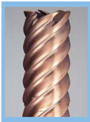
Illustration de l'usure d 8 mm, après une durée d'utilisation de 58 min
