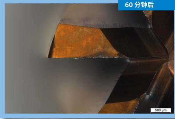
**带 DURO-Si 涂层的 XFeed-H**
