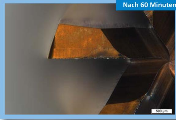
**XFeed-H mit DURO-Si-Beschichtung**
