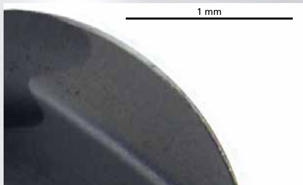
MicrospheriXG nach 4 h Eingriffszeit Aufnahme mittels Lichtmikroskop
