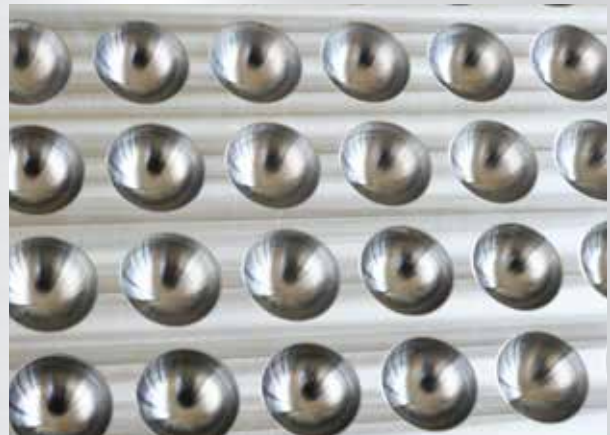
Präzisionsgefräste Kugelkalotten ( \varnothing = 5 \text{ mm} )
