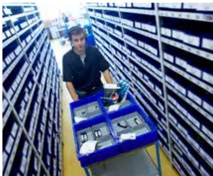
Con ToolCare® è possibile immagazzinare in modo chiaro gli utensili utilizzati nella produzione e gestirli con efficienza. Mediante cassette e utensili dotati di diciture, l'armadio utensili FRAISA assicura in ogni momento una conservazione sicura, pulita e ordinata degli utensili. In questo modo si evitano errori e si accelerano i processi di lavoro.
