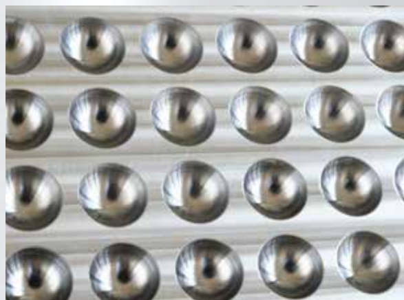
Calotte sferiche con fresatura di precisione ( \varnothing = 5 mm)
